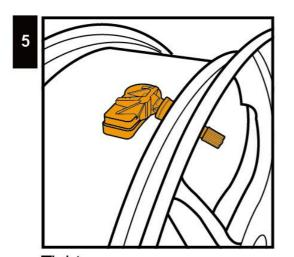
Tighten up screw 先調整無線傳感器的角度並盡量 貼附於鋁鋼圈上,再鎖緊固定
