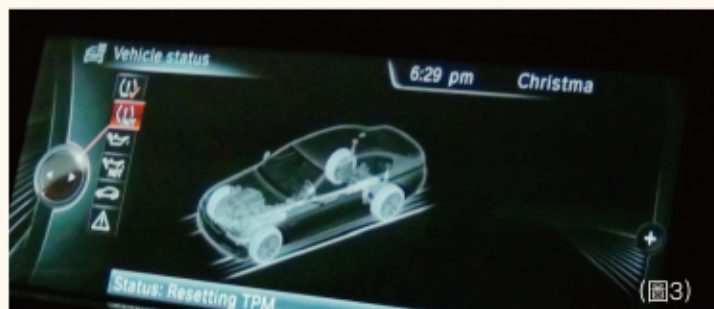
車輛顯示四顆輪胎無顏色(圖3)， 準備重新學習Sensor識別碼。
